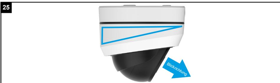
Achten Sie auf die Neigung des Gehäuses. Die weiße Abdeckung passt nur korrekt auf die Kamera, wenn die Neigung der Abdeckung synchron mit der Kamera ist.
