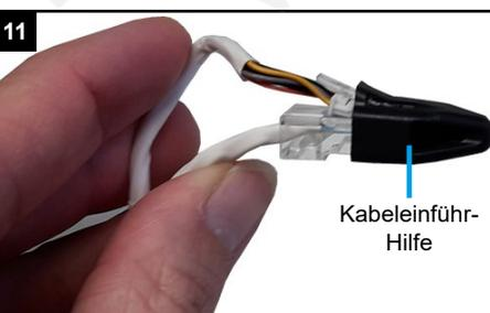
Setzen Sie die Kabeleinführ-Hilfe auf die Anschlussstecker für die Kamera.
