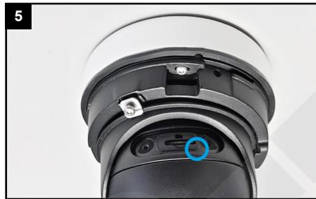
Reset: Betätigen Sie die Reset-Taste fünf Sekunden lang, wenn Sie die Kamera auf ihre Werkseinstellungen zurücksetzen möchten.
