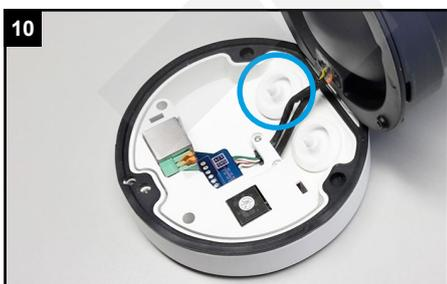
Verwenden Sie die Kabelzufuhr, die am Gehäuseboden mit „POE CABLE“ gekennzeichnet ist, für das Netzwerkkabel. Die andere Kabelzufuhr ist für 12V- oder Alarm-Kabel.
