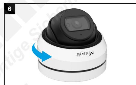
Drehen Sie die obere weiße Abdeckung in Pfeilrichtung, um sie zu lösen.
