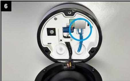
Schließen Sie das Kabel an der Netzwerkbuchse an.
