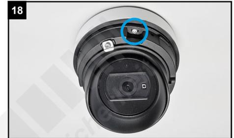
Schwenken Sie das Kameramodul wieder zurück und ziehen Sie die Feststellschraube feste an.
