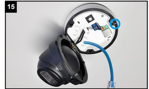
Ziehen Sie die Fixierschraube feste an, bis die Kamera einen stabilen Halt hat. Prüfen Sie den Halt der Kamera.
