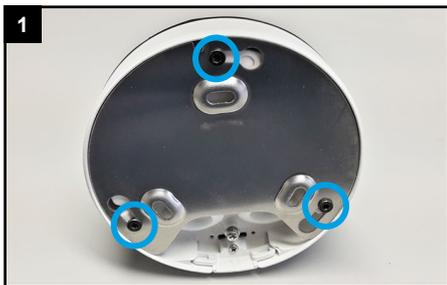
Auf der Rückseite der Kamera befindet sich eine Montageplatte. Lockern Sie die drei schwarzen Schrauben ein wenig, bis Sie die Montageplatte bewegen / drehen können.
