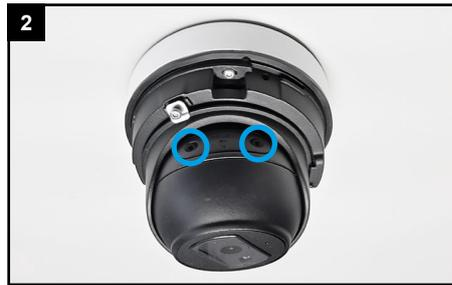
Auf der Rückseite der Kamera befindet sich eine kleine schwarze Abdeckung. Lösen Sie die beiden Schrauben und nehmen Sie die Abdeckung ab.
