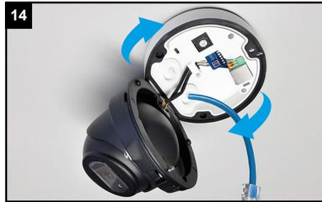
Drehen Sie Die Kamera bis zum Anschlag auf die Montageplatte.
