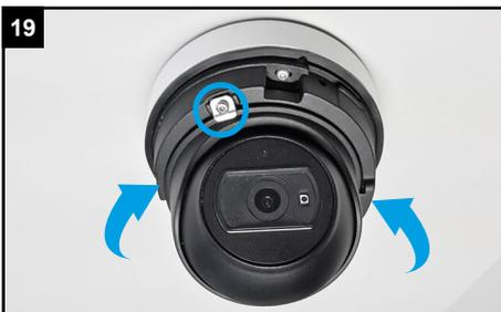
An der Seite befindet sich eine weitere Befestigungs-Schraube. Lösen Sie diese ein wenig, bis Sie die Blickrichtung der Kamera verstellen können.
